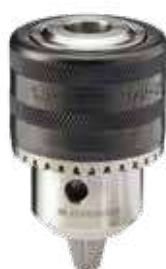
Mandril de perfuração DIA Ø 1.5 - 13 mm, Conexão 1/2" x 20 UNF
