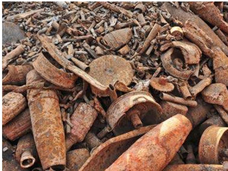
Entsorgung von chemischen Kampfstoffen und Rüstungsaltlasten in Munster am 30. Oktober 2013. Im Sprengofen werden chemische und konventionelle Munition sowie sonstige explosive Abfälle thermisch entsorgt. Was bleibt ist ungefährlicher Metallschrott. (Bild: Carl Schulze)
