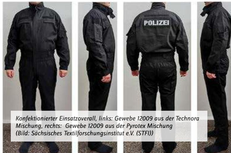
Konfektionierter Einsatzoverall, links: Gewebe 12009 aus der Technora Mischung, rechts: Gewebe 12009 aus der Pyrotex Mischung (Bild: Sächsisches Textilforschungsinstitut e.V. (STFI))
