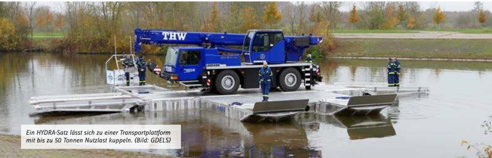
Ein HYDRA-Satz lässt sich zu einer Transportplattform mit bis zu 50 Tonnen Nutzlast kuppeln. (Bild: GDELS)
