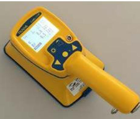
Die technisch modifizierten Geräte reagieren auf Funkwellen (DoMo SIM) bzw. auf Magnetfelder (CoMo SIM) und können somit ohne radioaktive Quellen für Übungen genutzt werden.
