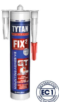
Adeziv de montaj foarte puternic cu întărire rapidă, hibrid pe bază de MS Polimer. Este de neînlătuit în montajele cu efect de aderență inițială rapidă (atunci când vrem să lipim rapid două materiale). Formează o lipitură foarte puternică care poate fi încărcată după aproximativ 30 de minute de la aplicare și își atinge rezistență maximă după aproximativ 3 ore. Îmbinarea rezultată amortizează perfect vibrații, adezivul este rezistent la intemperii, radiații UV și substanțe chimice.
