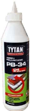
Adeziv poliuretanic mono component care se întărește atunci când este expus la umezeala din aer sau umezeala suportului. Odată uscat, creează o îmbinare durabilă, flexibilă rezistent la o gamă largă de temperaturi, cu clasa de rezistență la apă D4 (în conformitate cu standardul EN 204).
