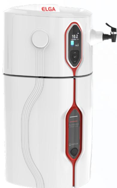
El sistema diseñado para proveer una tasa de producción de agua tipo I ASTM ( $18.2 \text{ M}\Omega \cdot \text{cm}$ ) de 10 l/h a 20 l/h a elección del usuario, integra la tecnología de punta para la recirculación de agua para garantizar la calidad en todo momento, su diseño le permite ajustarse a la condiciones del laboratorio, cuenta con cuatro opciones de almacenamiento de agua de 15l, 30l, 60l y 100l.
