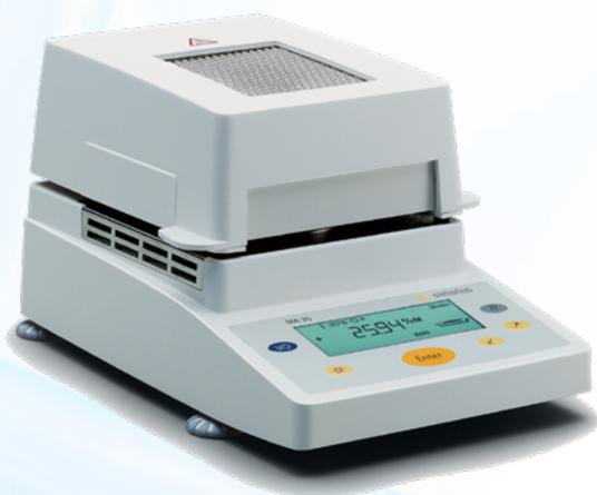
El modelo MA35 se caracteriza por ser un analizador de humedad práctico y sencillo de ocupar dentro de los laboratorios académicos, su elemento calefactor metálico hace que la radiación infrarroja en la muestra sea suavizada para obtener resultados de %humedad y %materia seca sean confiables.
