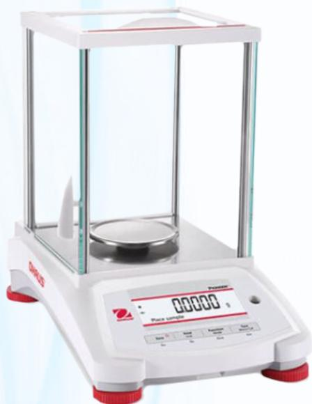
La Balanza Analítica Pioneer PX combina la funcionalidad del pesaje esencial con un desempeño competitivo, ofreciendo una alta precisión y repetibilidad para las actividades de pesaje básico del laboratorio. La Balanza Analítica Pioneer PX está diseñada intuitivamente para un funcionamiento inteligente con una pantalla de segunda línea para obtener información adicional, conectividad USB y RS232 para facilitar la comunicación, barra de extracción de estática en su gabinete.
