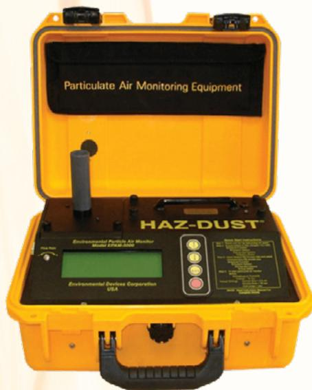
Opción adecuada para monitoreo de la calidad de aire en el área de trabajo, tanto en lugares interiores como exteriores. El equipo utiliza la dispersión de luz infrarroja para medir la concentración de partículas y proporcionar así determinaciones en tiempo real. Posee una sensibilidad de detección desde 0.001 hasta 20 mg/m<sup>3</sup>, para partículas de tamaño entre 0.1 a 100 µm.
