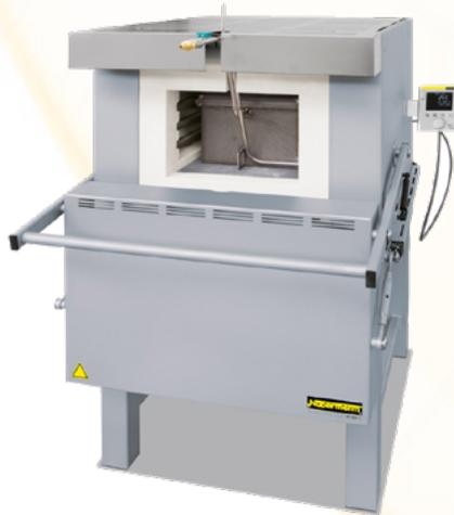
Los hornos de cámara de Nabertherm, resisten el trabajo duro para el tratamiento térmico de metales preciosos. Cuenta con un aislamiento de ladrillos refractarios que proporcionan un buen aislamiento al horno, calentamiento a tres lados y elementos calefactores apoyados en tubos de soporte que proporcionan una radiación libre del calor y una larga vida útil.
