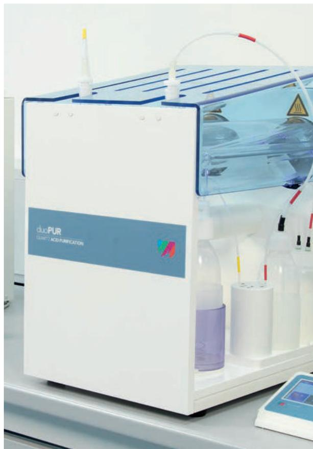
Figura 2. duoPUR de Milestone, sistema de destilación por sub-ebullición.
