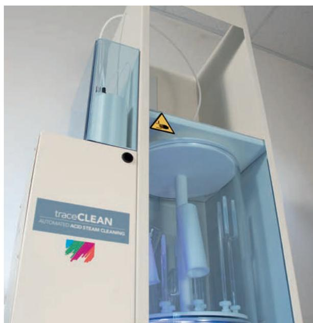
Figura 4. traceCLEAN de Milestone - sistema de limpieza con vapor de ácido
