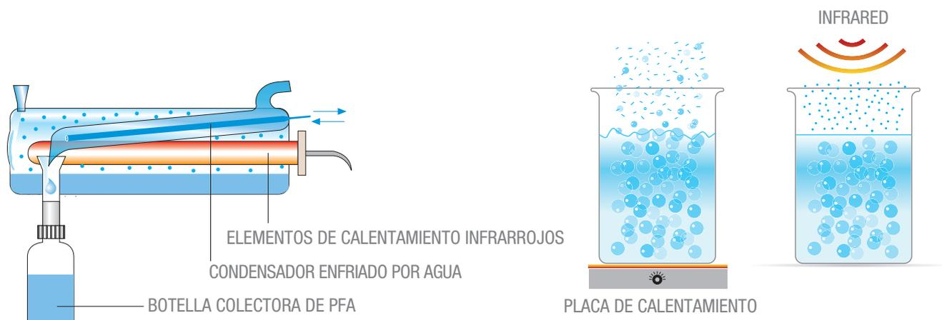
Figura 3. Procesos de evaporación por ebullición y sub-ebullición
