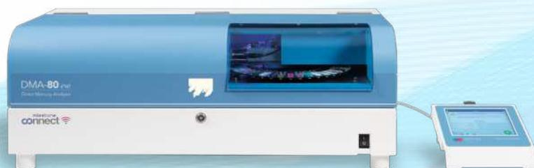
El DMA-80 evo de Milestone está referenciado en el método 7473 de la Agencia de Protección Ambiental de los Estados Unidos (US EPA), es un equipo que incorpora un automuestreador circular de 40 posiciones para navetas de Níquel y cuarzo dependiendo del tipo de aplicación. El principio de operación del equipo involucra una etapa de descomposición térmica, conversión catalítica, amalgamación y detección por Espectrofotometría de Absorción Atómica.
