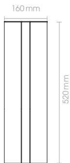
57226-52 230V · LED · 14W 954lm · 3000K A 50 mm
