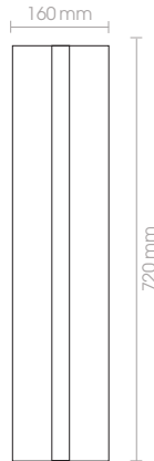
57226-72 230V · LED · 20W 1362lm · 3000K A 50 mm
