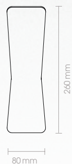
57210-8 230V · LED · 6W 560lm · 3000K A 88 mm
