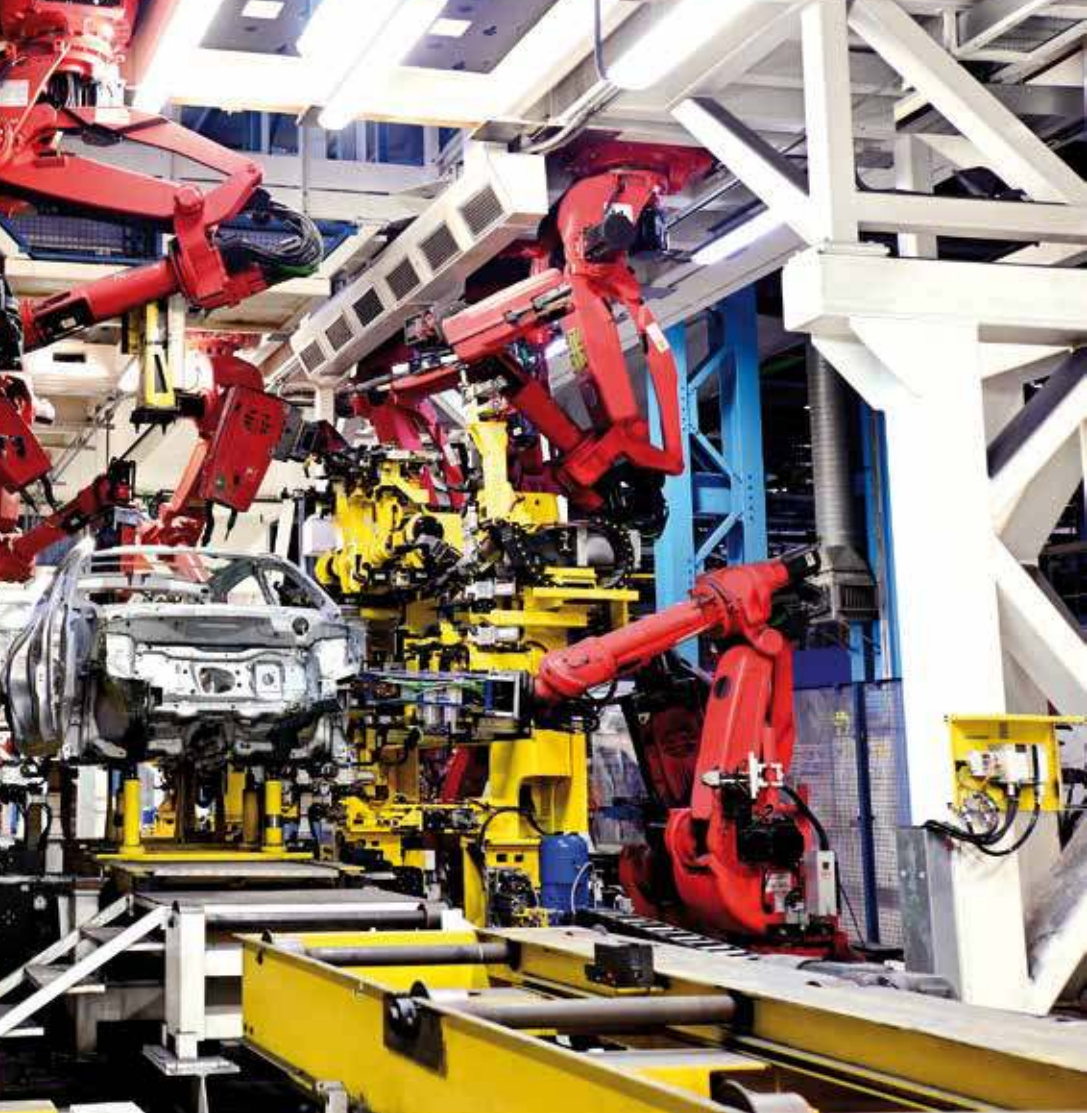
Linea di produzione del SUV Tonale di Alfa Romeo totalmente automatizzata da Comau. L'automotive resta uno dei principali campi applicativi dei robot nel mondo.
