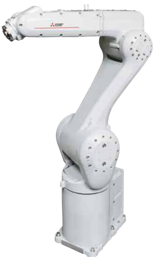
Il robot antropomorfo RV-8CRL, da 8 kg di payload, sbraccio da 931 mm e grado di protezione IP65, è ideale per operare anche in ambienti dove è presente olio nebulizzato.
