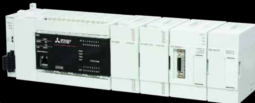
PLC della serie FX5 di Mitsubishi Electric utilizzato per gestire l'automazione dei magazzini ONO Lean Logistics.
