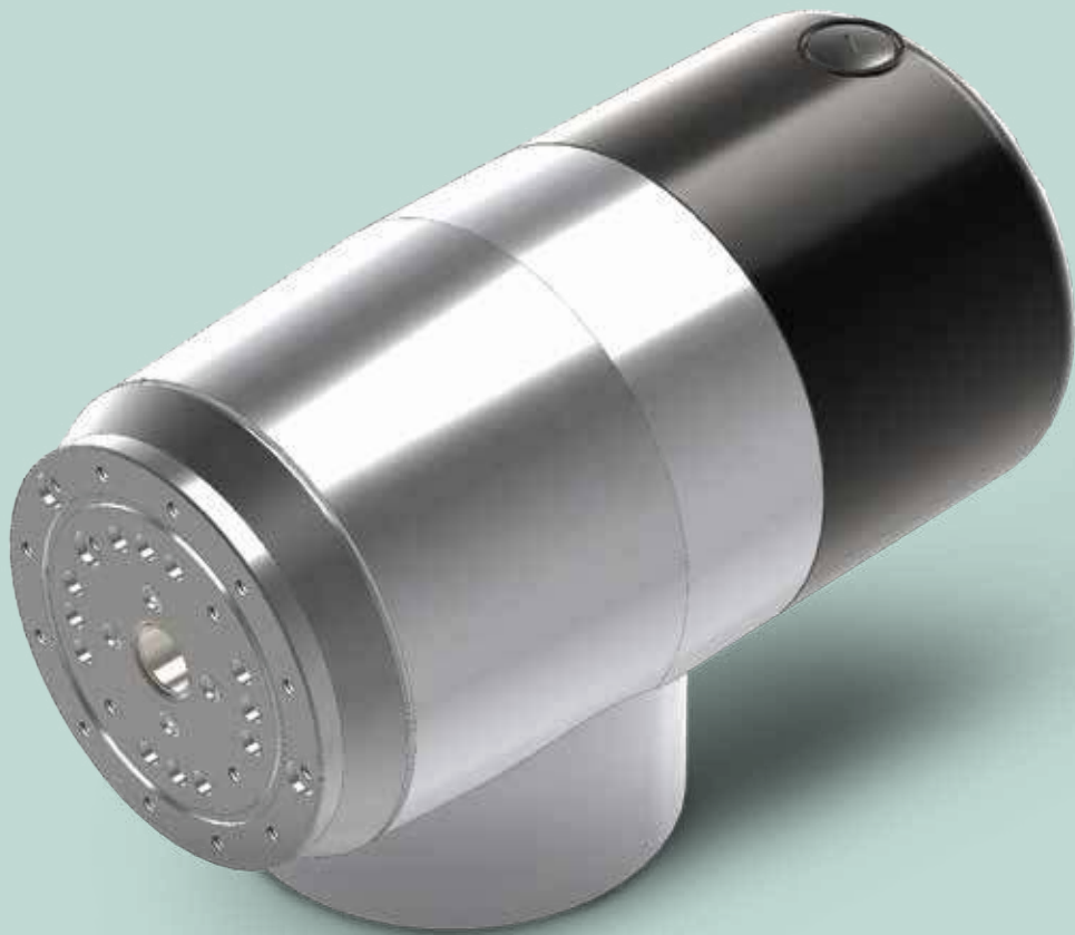
J17 uno dei giunti di nuova generazione sviluppati da AutomationWare e commercializzati con la denominazione di J-Actuators.
