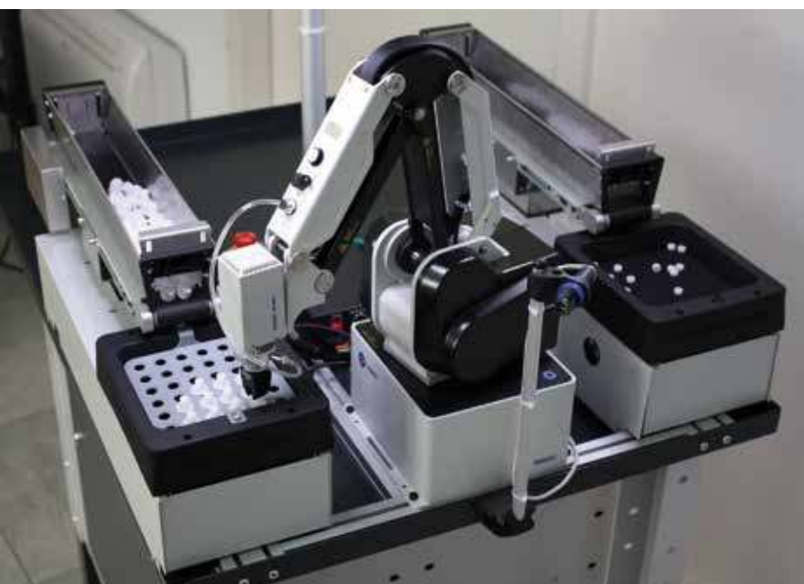
ROBO FLEXI FEEDER attrezzato con un robot collaborativo Dobot. Il sistema consente l'alimentazione rapida e precisa del cobot per la pallettizzazione.
