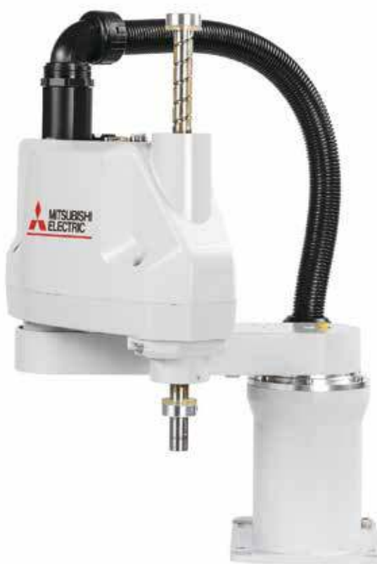
Il robot RH-3CRH da 3 kg di payload, uno degli SCARA della gamma MELFA di Mitsubishi Electric, che annovera modelli da 3 a 6 kg e sbraccio da 300 a 700 mm.
