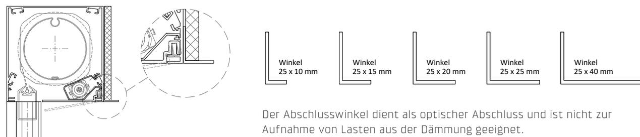
Der Abschlusswinkel dient als optischer Abschluss und ist nicht zur Aufnahme von Lasten aus der Dämmung geeignet.
